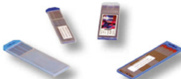
Volfram elektrode (zelene (100 % W), sive (2 % Ce), rumene (1,5 % La) ...)
