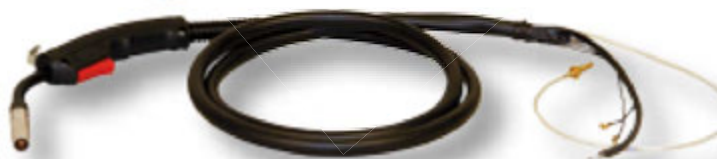
Direktni MIG gorilnik MG 15 (2 m; do 170 A; za »hobi« naprave z direktno priključitvijo)
