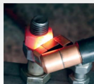
> Segrevanje matice s fokusno tuljavo pod kotom
