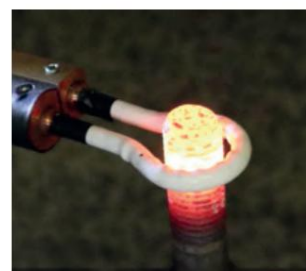
> Ogrevanje navojnega vijaka z vodno hlajeno tuljavo
