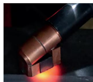
> Ogrevanje komponente s fokusno tuljavo pod kotom
